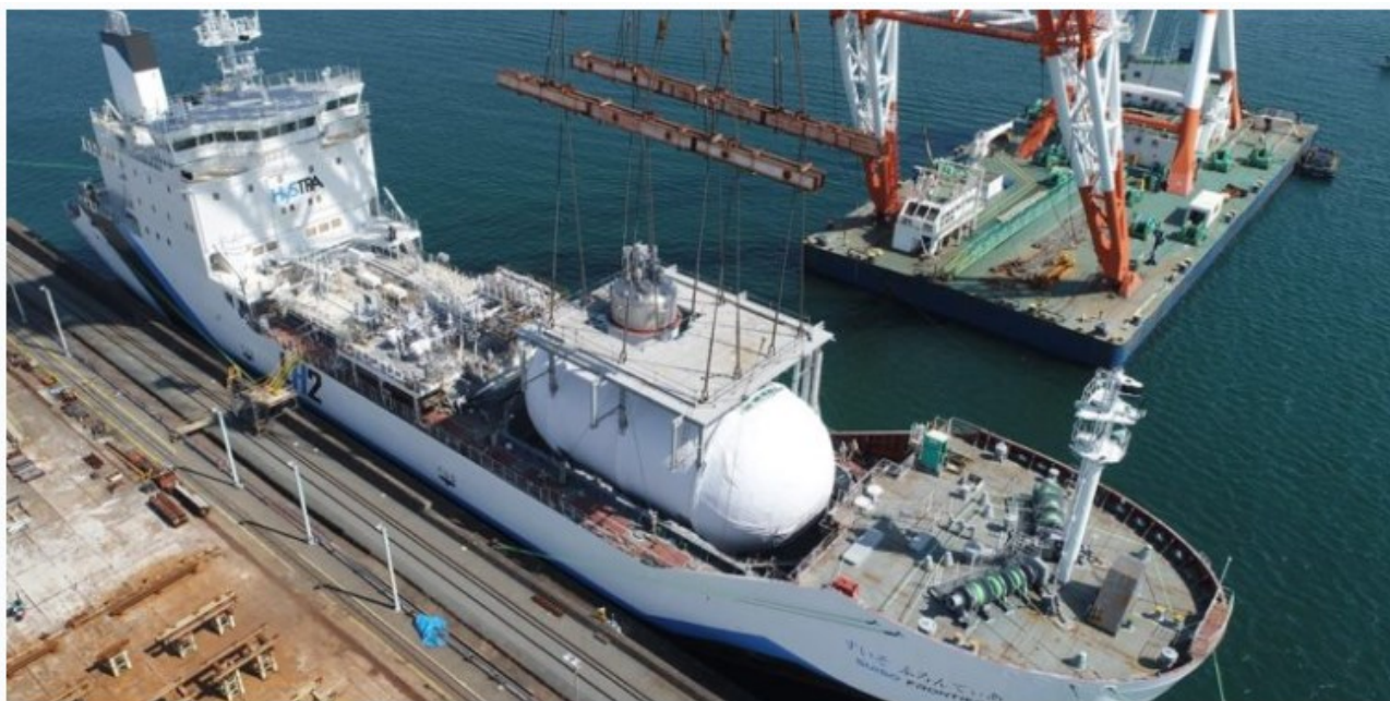
4 pav. LH 2 talpos montavimas į pirmąjį LH 2 tanklaivį „Suiso Frontier“
