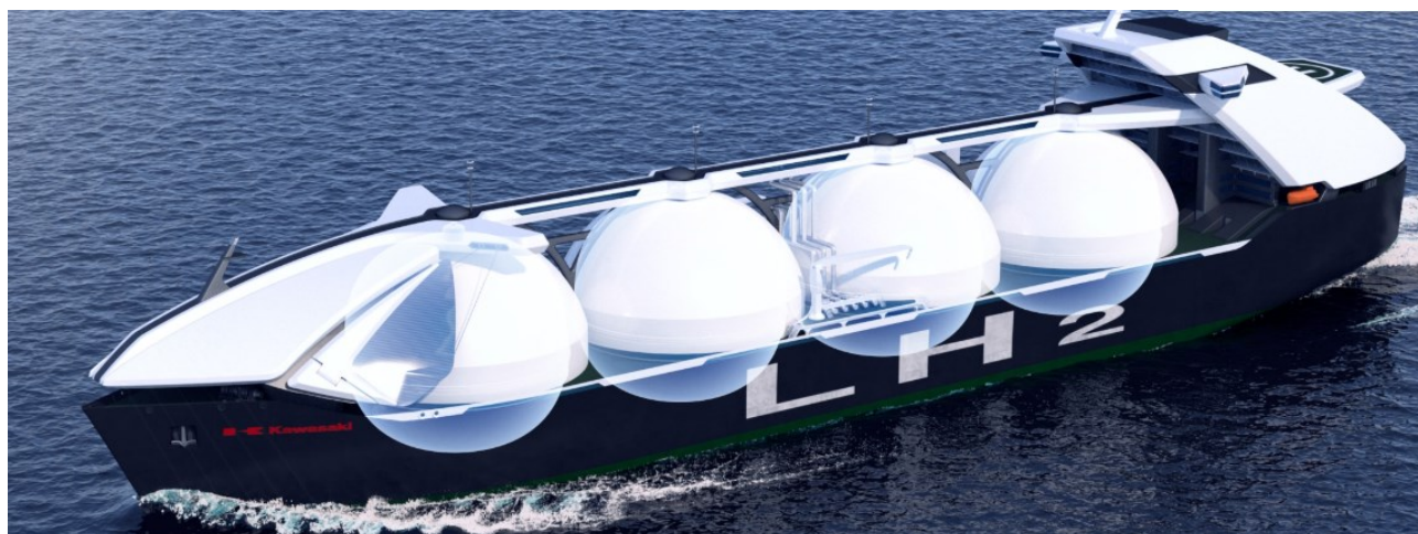
5 pav. Naujasis Kawasaki Heavy Industries laivas, galintis gabenti 160 000 m 3 LH 2
