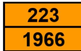
3 pav. Pavojingumo lentelės pavyzdys suslėgtam vandeniliui ir skystam vandeniliui
