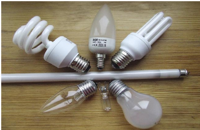
9.1 pav. Kompaktinės fluorescencinės A klasės lemputės (viršuje, iš kraštų), 1 W šviesos diodų lemputė (viršuje, viduryje), linijinė fluorescencinė lempa (viduryje), kaitrinės F ir E klasės lemputės (apačioje, iš kraštų), halogeninė C klasės lemputė (apačioje, viduryje).
