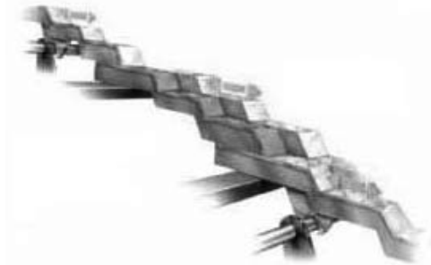
4.5 pav. Švedijos bendrovės KMW ENERGI AB kūrykla TRF su šachmatine tvarka judančiais ardyno elementais
