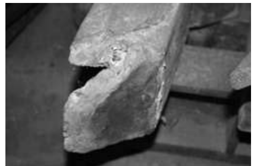
8.15 pav. Ardyno elementas pradegusia priekine dalimi. Ū. Kask nuotrauka
