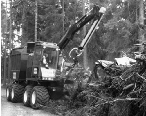
3.38 pav. Kilnojamasis smulkintuvas–medvežė, Erjofanten 7/65. P. Muiste nuotrauka
