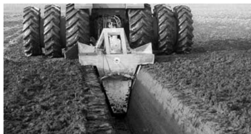
3.65 pav. Drenažo griovių išspaudimas durpyno dirvožemyje Suomijos bendrovės SUOKONE OY pagamintu agregatu OJ-1.3K
