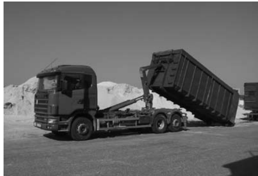
3.20 pav. Skiedrų gabenimas konteineriniu sunkvežimiu. P. Muiste nuotrauka
