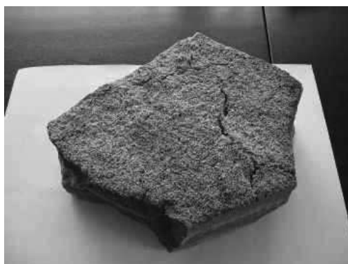
8.40 pav. Iš kūryklos pašalintas nuosėdų gabalas. Ū. Kask nuotrauka
