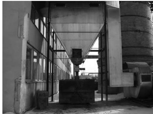
B. Konteineris po pelenų bunkeriu. Tarp bunkerio ir konteinerio matomas besisukantis vožtuvas.
