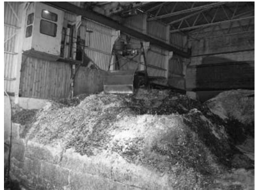
8.32 pav. Operatoriaus valdomas tiltinis kranas su griebtuvu. Ū. Kask nuotrauka
