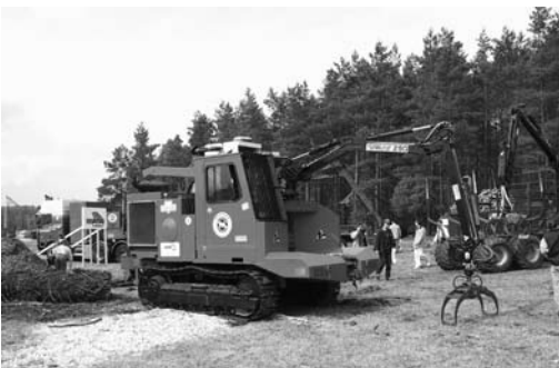
3.40 pav. Ekskavatorius kaip bazinė mašina smulkintuvui. P. Muiste nuotrauka
