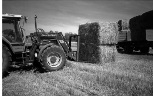
3.62 pav. Šiaudų ryšulių krovimas traktoriuje sumontuotu krautuvu [44]
