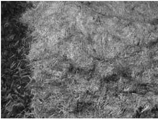
8.11 pav. Skiedros, susmulkintos plaktukiniu malūnu. Ū. Kask nuotrauka
