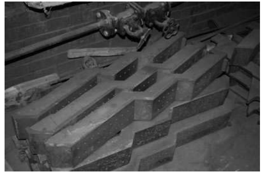
8.13 pav. Nauji ardyno elementai, pagaminti Tartu liejykloje. Ū. Kask nuotrauka
