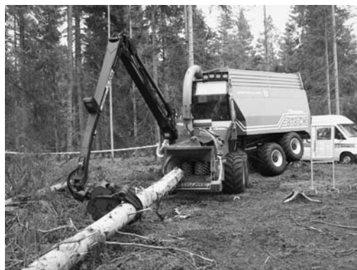
3.36 pav. Kilnojamas smulkintuvas–medvežė, Silvatec 878 CH [29]. P. Muiste nuotrauka
