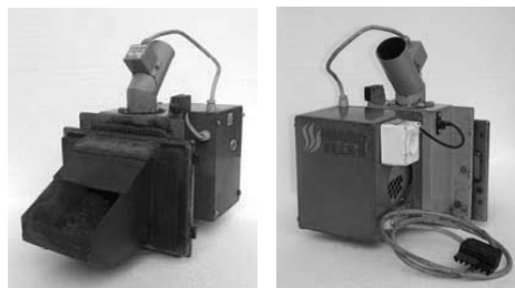
4.28 pav. Mažasis katilas Pelle su granulių bunkeriu, maitintuvu ir degikliu Iwabo VillaS, sukurtu Talino technologijos universitete
