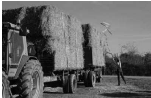
3.63 pav. Šiaudų ryšulių tvirtinimas transportavimo diržais krovinio stabilumo užtikrinimui [44]
