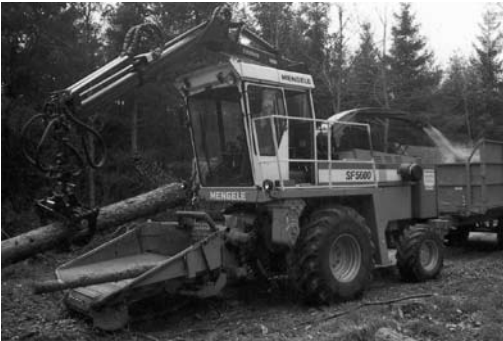
3.39 pav. Kombainas kaip bazinė mašina [31]
