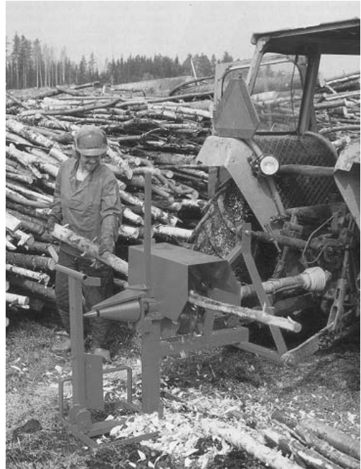
3.49 pav. Medienos kapoklė sujungta su žievės šalinimo įrenginiu [37]
