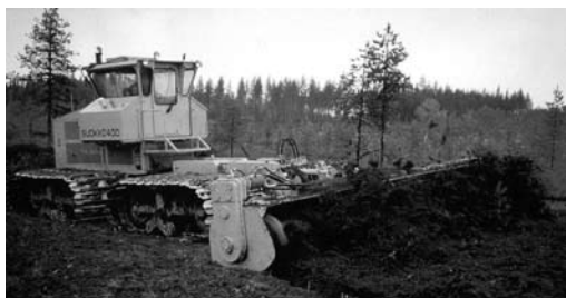
3.64 pav. Augmenijos šalinimas ir durpyno paviršiaus lyginimas Suomijos bendrovės SUOKONE OY pagamintu agregatu RT-6.0H
