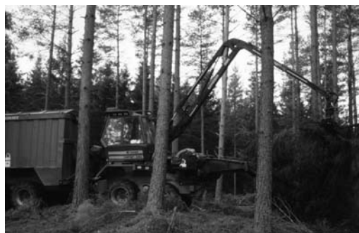
3.10 pav. Kirtimo atliekų surinkimas ir smulkinimas kilnojamoju smulkintuvu–medveže Chipset 536C. P. Muiste nuotrauka
