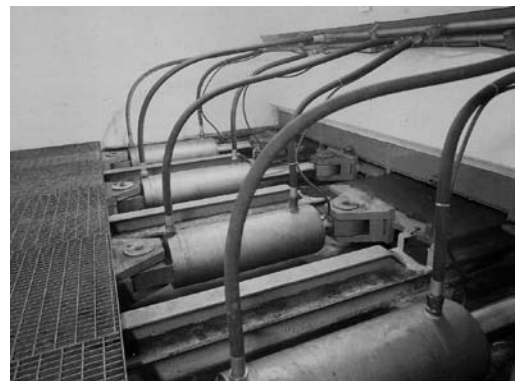
5.6 pav. Hidrauliniai cilindrai, varantys stumiamųjų grindų elementus (Saxlund)
