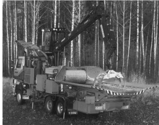
3.41 pav. Smulkintuvas, sumontuotas ant sunkvežimio Giant [32]
