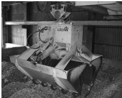
5.4 pav. Greiferinis kranas. Ū. Kask nuotrauka
