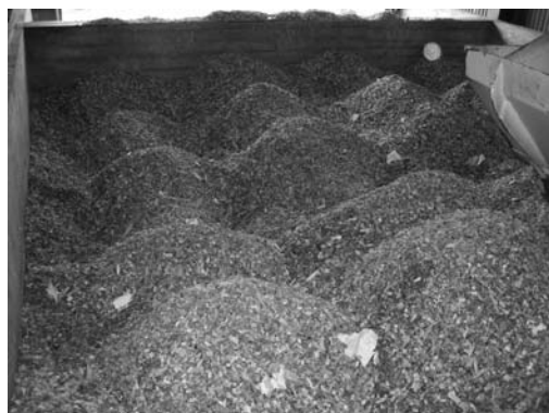
8.10 pav. Kompiuteriu valdomas greiferinis kranas paskirstė kurą tolygiai po visą sandėlio plotą. Ū. Kask nuotrauka
