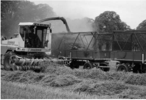
3.60 pav. Dirbanti savaeigė kapijtinė [44]
