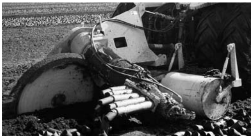
3.66 pav. Durpių masės frezavimas iš durpyno ir gabalinių durpių išgavimas Suomijos bendrovės SUOKONE OY pagamintu agregatu PK-1S
