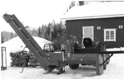
3.51 pav. Kapoklės su hidrauline pavara [39]
