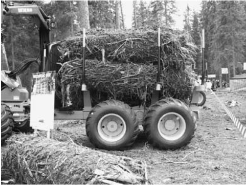
3.48 pav. Supakuotų miško atliekų gabeni- mui gali būti naudojama paprasta medvežės priekaba. P. Muiste nuotrauka
