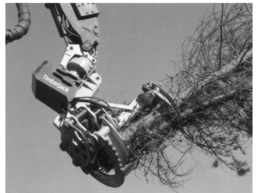
3.53 pav. Surenkanči kirtimo galvutė Timberjack 720 ir Timberjack 730 [35]
