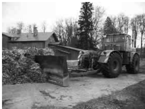
8.31 pav. Traktorius, pritaikytas kuro stumdymui, Ü. Kask nuotrauka
