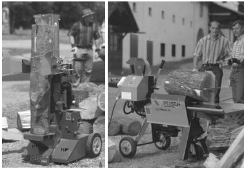
3.51 pav. Kapoklės su hidrauline pavara [39]
